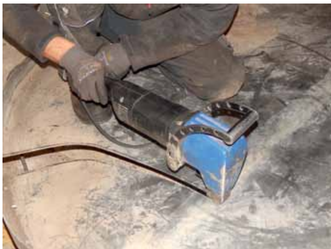
Ist das TruTool N 700 richtig angesetzt, genügt eine Hand und der Nibbler knabbert mit 1,3 Meter pro Minute durch bis zu sieben Millimeter dicken Baustahl.
