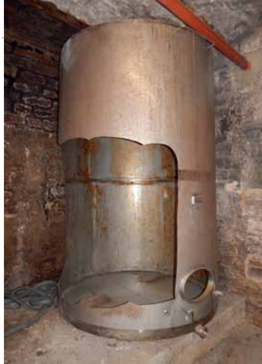
Mit dem Nibbler TruTool N 700 schneidet Angelo Lenhart die Tanks in handliche Streifen.
