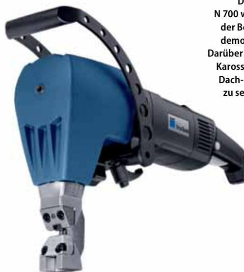
Ist das TruTool N 700 richtig angesetzt, genügt eine Hand und der Nibbler knabbert mit 1,3 Meter pro Minute durch bis zu sieben Millimeter dicken Baustahl.
